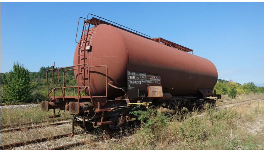
Εικόνα 5.6: Βυτιοφόρο βαγόνι στο Σταθμό Υγρών Καυσίμων των λιγνιτωρυχείων, ονομαστικής χωρητικότητας 61.530 l και απόβαρου 22,8 t.
