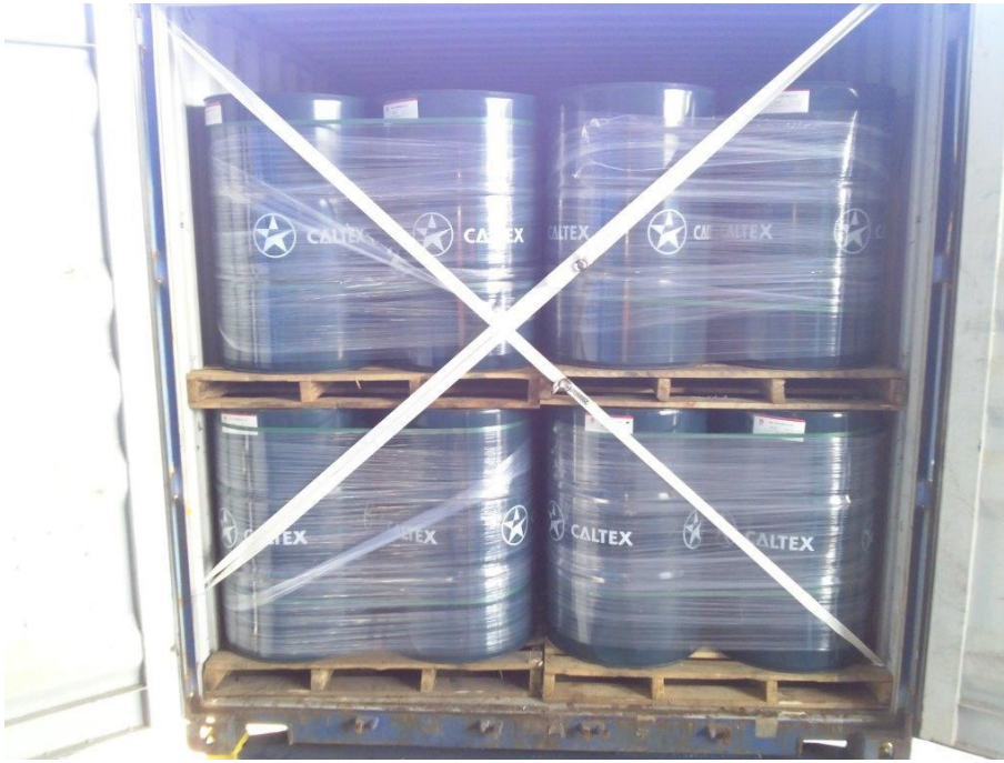
Εικόνα 5.8: Φόρτωση 20 παλετών (80 βαρέλια) σε εμπορευματοκιβώτιο 20' pallet-wide με πλήρη εκμετάλλευση του χώρου.
