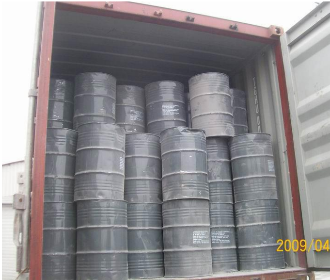
Εικόνα 5.14: Φόρτωση κενών βαρελιών σε εμπορευματοκιβώτιο. Χωρητικότητα E/K 40' High Cube: 240 κενά βαρέλια. (© Africa-Trade.ci)
