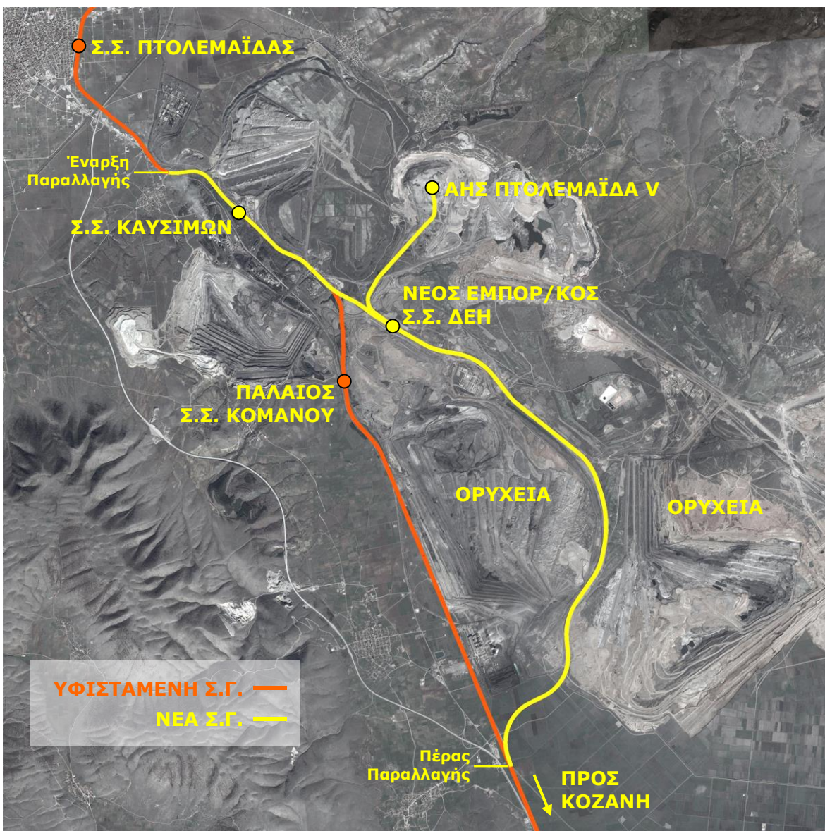
Εικόνα 4.5: Υπό κατασκευή παραλλαγή Σιδηροδρομικής Γραμμής Πτολεμαΐδας – Κοζάνης στο τμήμα Προάστιο – Μαυροδένδρι, λόγω επέκτασης των λιγνιτωρυχείων.
