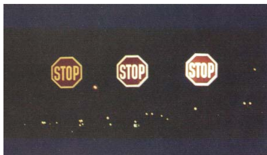
Εικόνα 3.2: Οι τρεις τύποι αντανακλαστικών μεμβρανών, υπό το φως προβολέων οχήματος.
