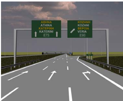
Εικόνα 3.13: Γέφυρα σήμανσης (Π-85) πριν από το σημείο απόσπασης λωρίδας.
