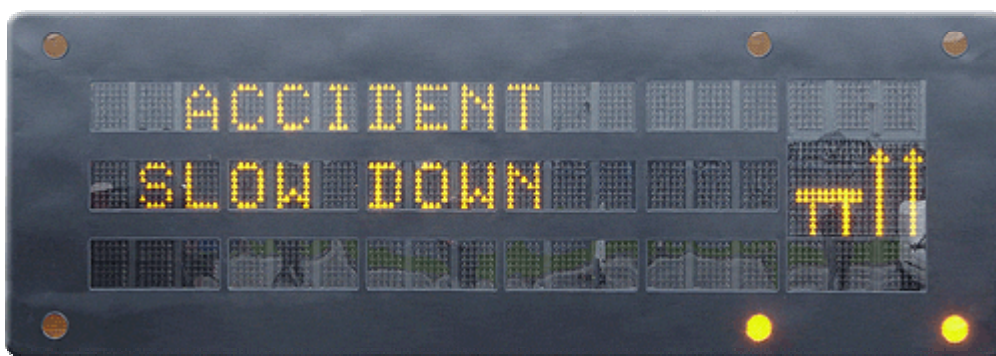
Εικόνα 4.3: Πινακίδα Μεταβλητών Μηνυμάτων με διόδους LED.
