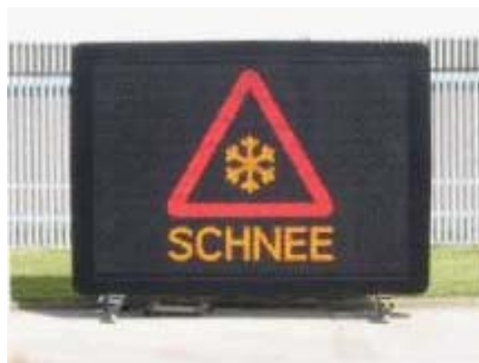
Εικόνα 4.5: Εφαρμογή του συστήματος dual colour LED.
