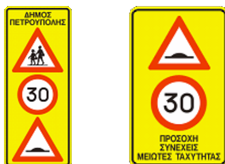
Εικόνα 3.4: Πινακίδες με υπόβαθρο από φθορίζουσα μεμβράνη.
