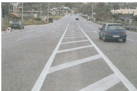
Εικόνα 2.1: Διαγράμμιση επιφάνειας αποκλεισμού οδοστρώματος.
