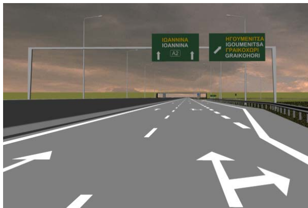
Εικόνα 3.14: Γέφυρα σήμανσης (Π-85) στο σημείο έναρξης της λωρίδας επιβράδυνσης.
