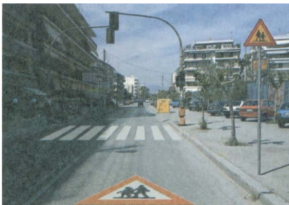
Εικόνα 2.5: Επανάληψη επάνω στο οδόστρωμα σήματος πινακίδας.
