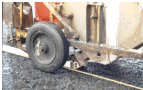
Εικόνα 2.9: Λεπτομέρεια του μηχανισμού. Στο πίσω μέρος διακρίνεται η θήκη με τα γυάλινα σφαιρίδια, τα οποία στη συγκεκριμένη περίπτωση διασπείρονται μετά την έγχυση του υλικού στο οδόστρωμα.
