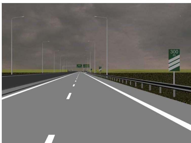
Εικόνα 3.12: Δείκτες απόστασης σημείου έναρξης λωρίδας επιβράδυνσης (Π-90).
