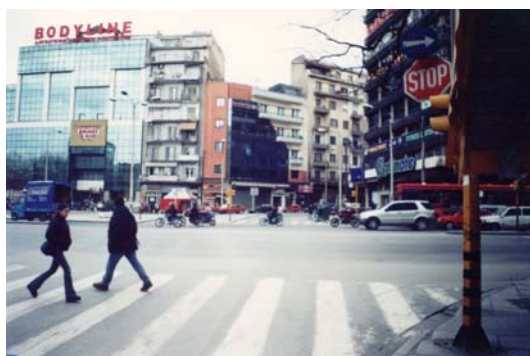
Εικόνα 11.15: Περιορισμός της ορατότητας του σηματοδότη από... περίπτερο.
