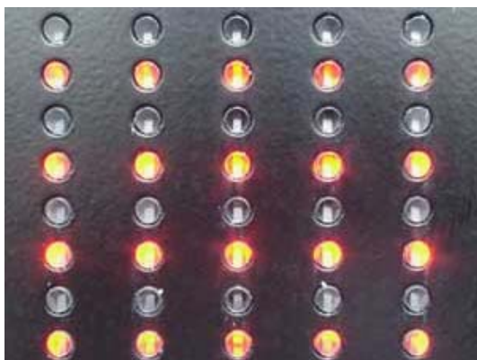
Εικόνα 4.4: Λεπτομέρεια από σύστημα απεικόνισης dual colour LED.
