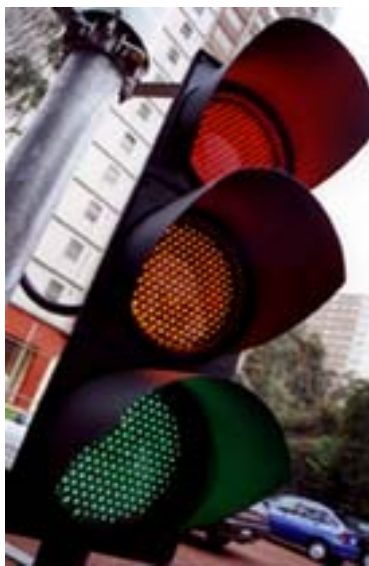
Εικόνα 5.16: Μορφή σηματοδότη με φωτισμό τύπου LED.
