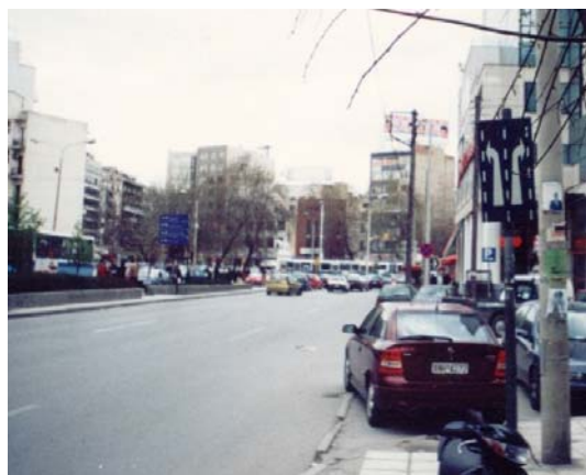
Εικόνα 11.11: Πινακίδα προεπιλογής λωρίδας στην οδό Λαγκαδά, η οποία ταυτόχρονα προειδοποιεί και για τη μη δυνατότητα συνέχισης προς ευθεία.
